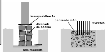
Alicerce em alvenaria de pedras
